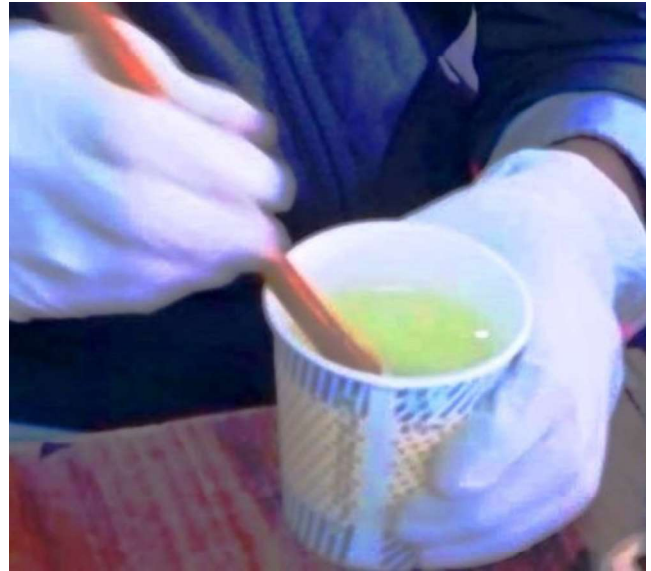
Fig. 2 Araldite LY556 + HY951 hardener (10:1 ratio)
